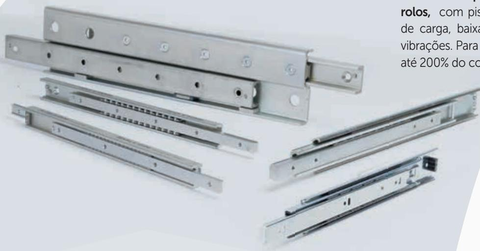
**Guias telescópicas com mancais de esferas e de rolos,** com pistas temperadas, altas capacidades de carga, baixa torção, resistentes a choques e vibrações. Para extração parcial, total ou estendida até 200% do comprimento da guia.
